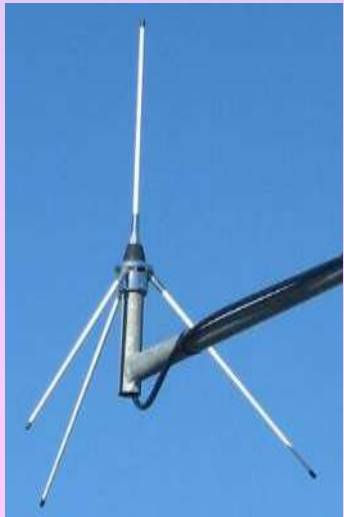
Ground-plane (vertical) Antenna
